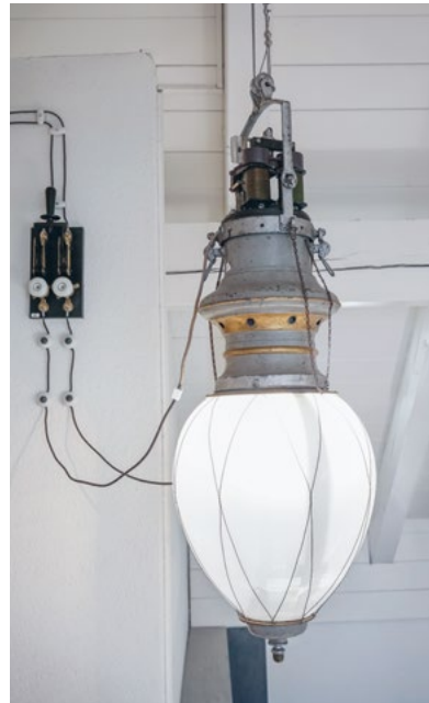
Die erste elektrische Lichtquelle war die Kohlebogenlampe
